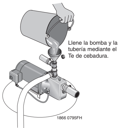
Figura 9: Cebadura de la bomba
